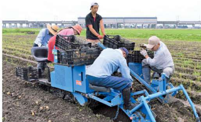
自走式の収穫機を使用した馬鈴薯の収穫作業
